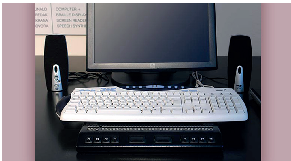
Slika 4. Brailleev redak kod stolnog računala (izvor: https://www.tifloloskimuzej.hr/hr/stalni-postav/ukorak-s-vremenom/predmet-brailleov-redak )
