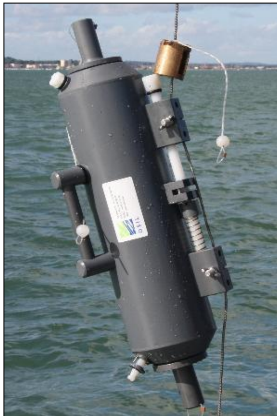
Slika 7. Niskinov crpac od 5 l za uzorkovanje morske vode
