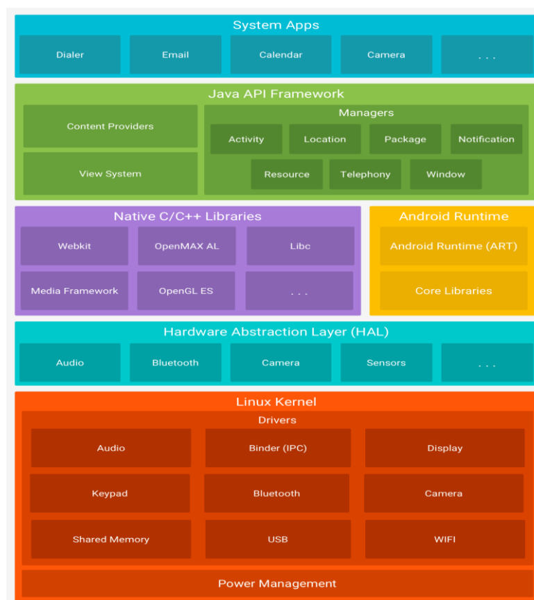
Slika 8. Stog operacijskog sustava Android, izvor:
