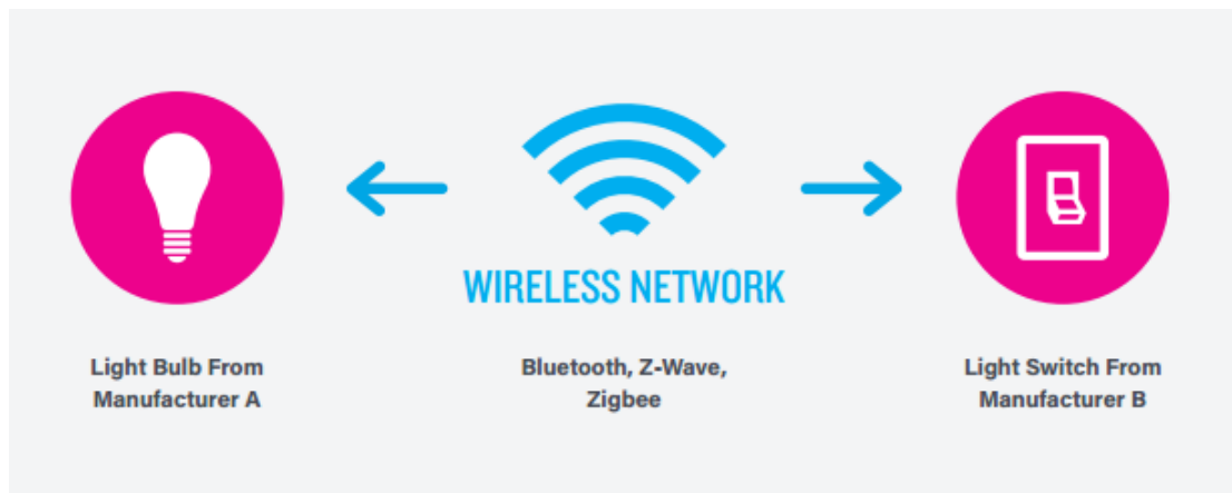
Slika 2. D2D komunikacijski model (Issack, 2017)
