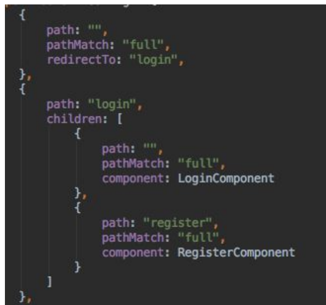
Slika 5. Primjer konfiguracije rutera
