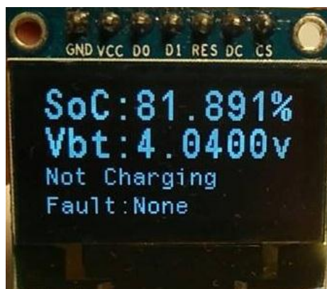
Slika 14: prikaz očitanih podataka na OLED ekranu
