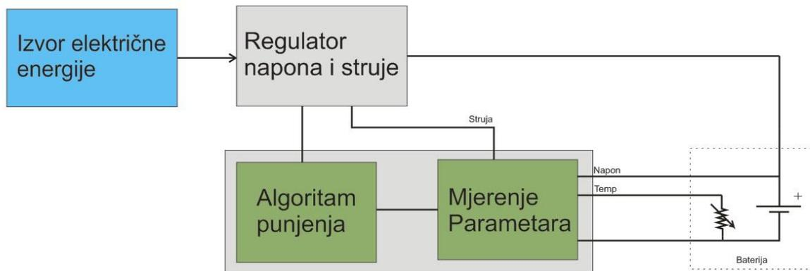
Slika 1: Blok shema punjača baterijske ćelije. (Power Electronics, Power bank- Power on the go)
