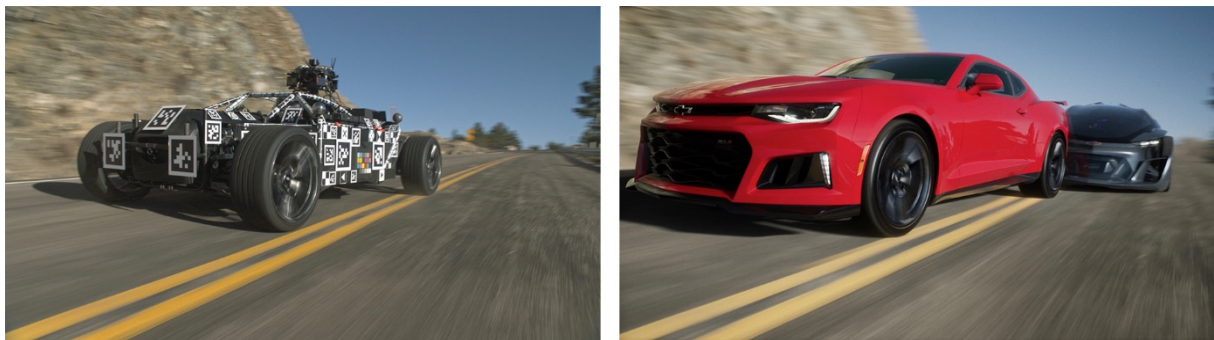
Slika 28. Mill Blackbird (lijevo) sirova snimka, Chevrolet Camaro ZL1 i Chevrolet FNR (desno) u kombinaciji sa Unreal Engine aplikacijom u realnom vremenu
