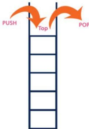
Slika 3. Primjer stoga (Btechsmartclass, 2015)
