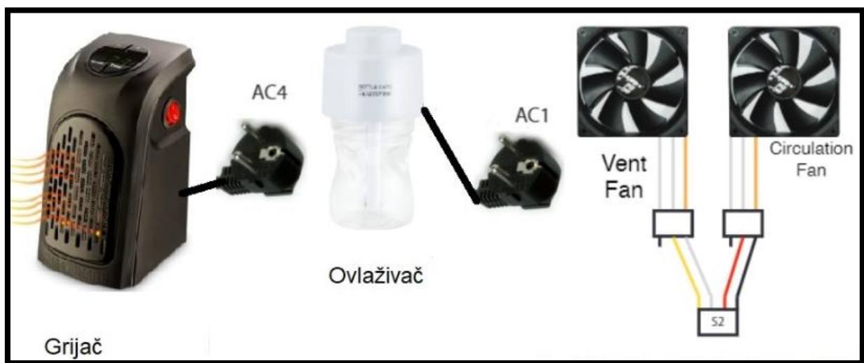
Slika 36. Shematski prikaz modula za izmjenjivanje zraka
