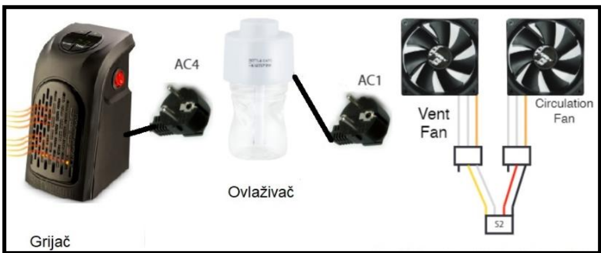
Slika 36. Shematski prikaz modula za izmjenjivanje zraka
