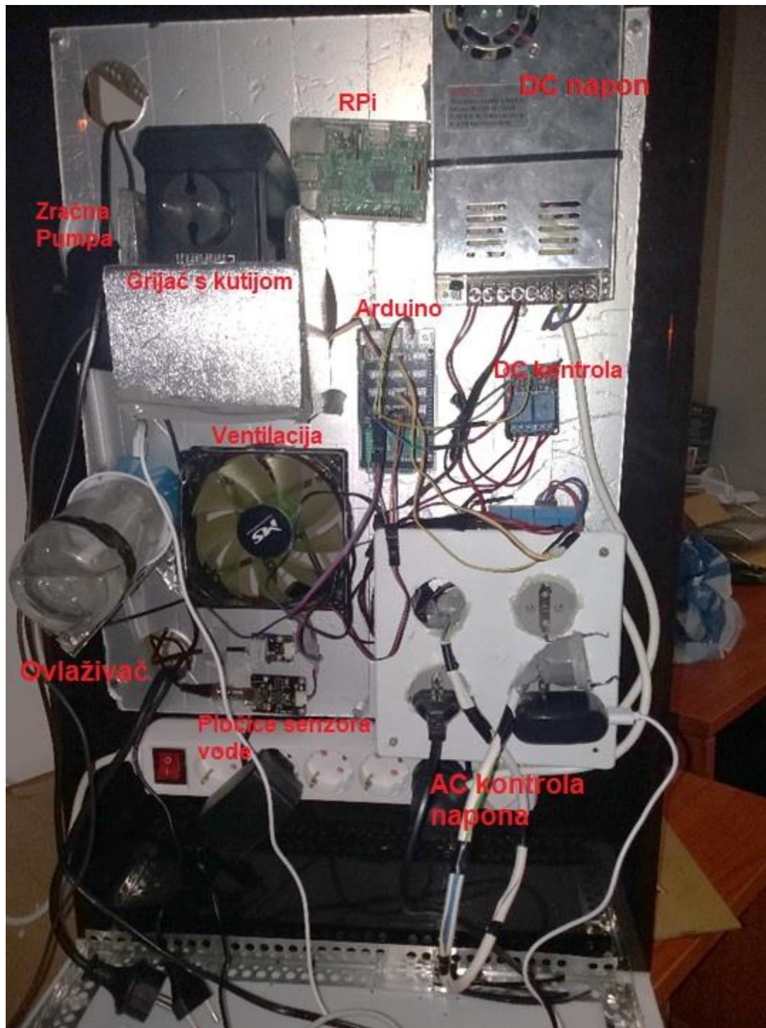
Slika 27. Stražnja strana matične ploče
