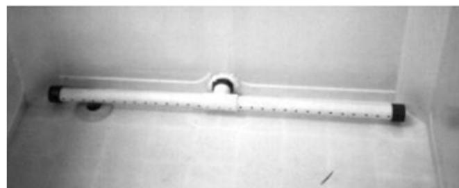
Slika 2. Cijev za odvod ([www.snatural.com.br/PDF\\_arquivos/Aquicultura-Seafish-Standard-Design-Purify-System.pdf](http://www.snatural.com.br/PDF_arquivos/Aquicultura-Seafish-Standard-Design-Purify-System.pdf)).
