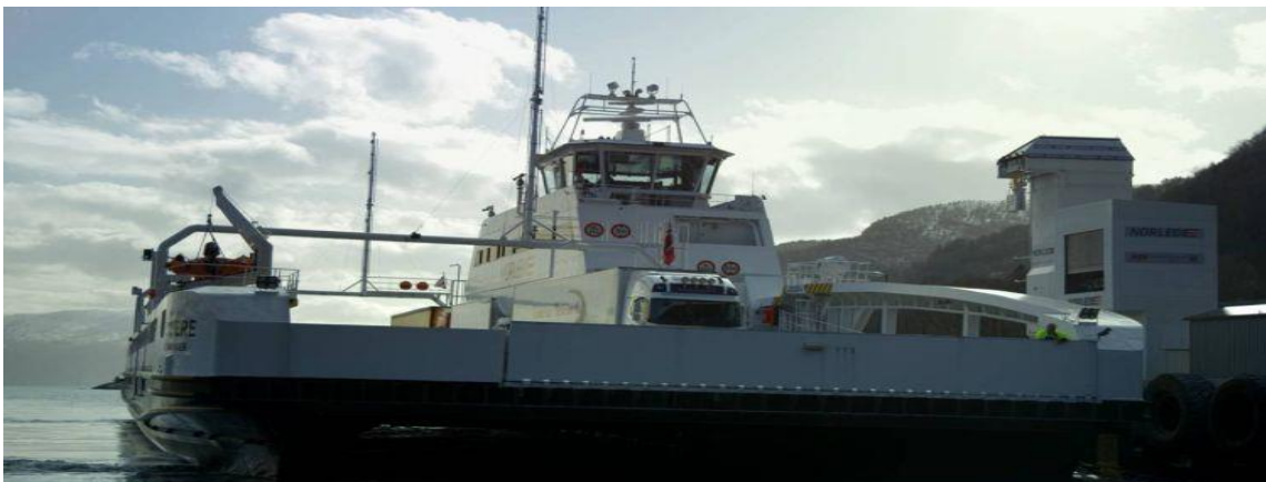
Slika 7. Trajekt na električni pogon
