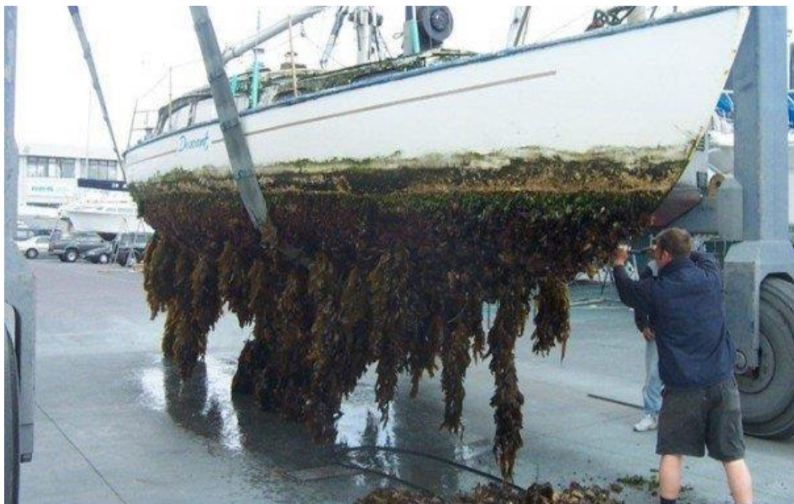
Slika 1. Obraštaj na brodu (izvor: https://smallboater.com/biofouling-guide/ )
