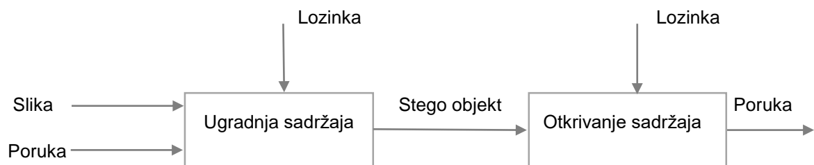
Slika 4. Proces steganografije tajnog ključa [6]
