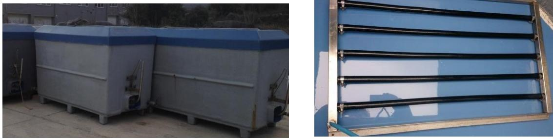
Slika 13. Oprema za prijenos mlađi do uzbunjivača (lijeva slika – spremnici za transport jedinka, desna slika – cijevi za dodatno ispuštanje kisika u spremnik) (Izvor: Novosel Brigita)
