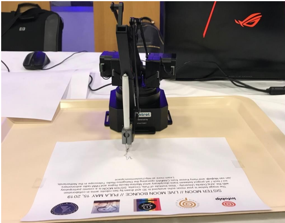
Slika 2. Ispis odjeka signala s Mjeseca pomoću robotske ruke
