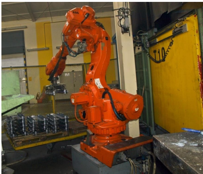
Slika 15. Robot na poslovima izvlačenja odljevka tlačnog lijeva, Tvornica radijatora u Lipovici (izvor: http://lipovica.hr/lib/plugins/thumb.php?src=upload_data/site_photos/web_006.jpg&w=1000&h=750&zc=3 )
