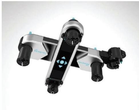
Slika 13. Mobilni robot za ispitivanje cijevi FORERUNNER tvrtke INETEC (izvor: http://www.infotrend.hr/userfiles/Image/casopis/200/Infotrend_200_z_a_web-2-045.jpg )
