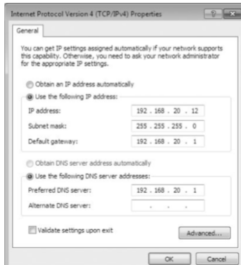
Slika 4. Postavljanje statičke IP adrese 5
