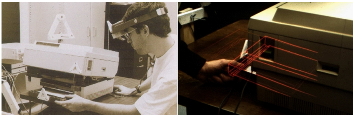
Slika 8 KARMA, sustav za pomoć pri održavanju i popravku printera
