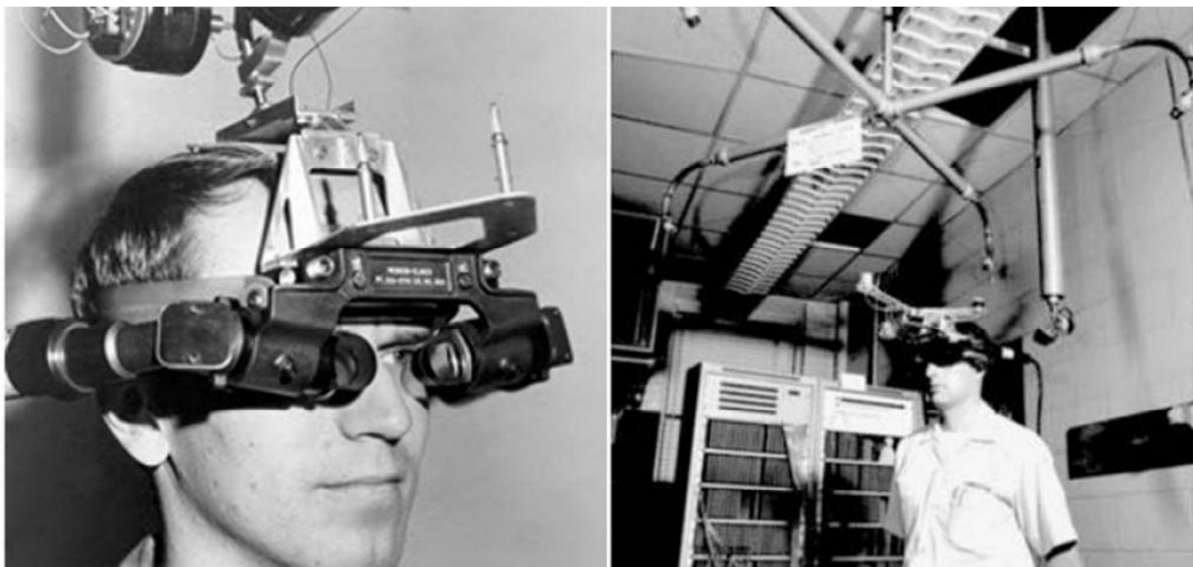
Slika 5 Prvi HMD uređaj, dijelo Ivana Sutherlanda
