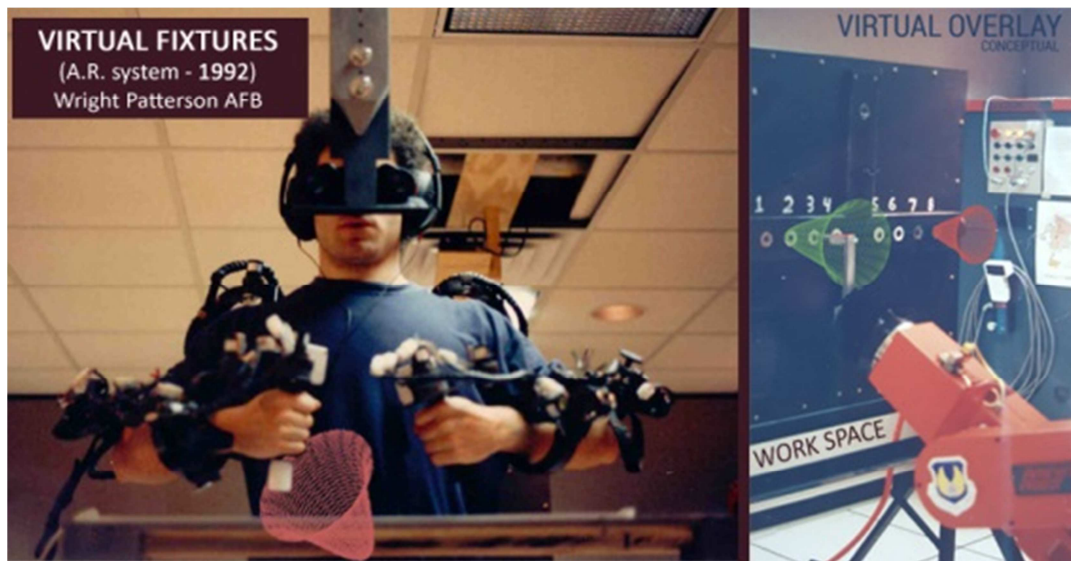
Slika 7 Virtual Fixtures, jedan od prvih funkcionalnih sustava proširene stvarnost
