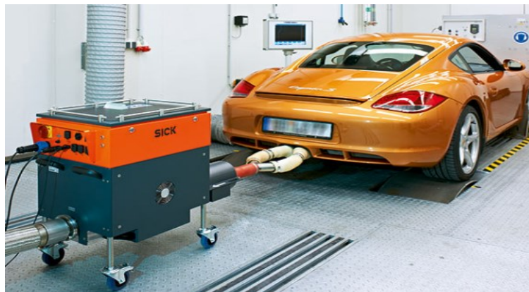
Slika 7. Automobil prikopčan na SICKov ultrazvučni plinski mjereni uređaj Flowsic150 Carflow
