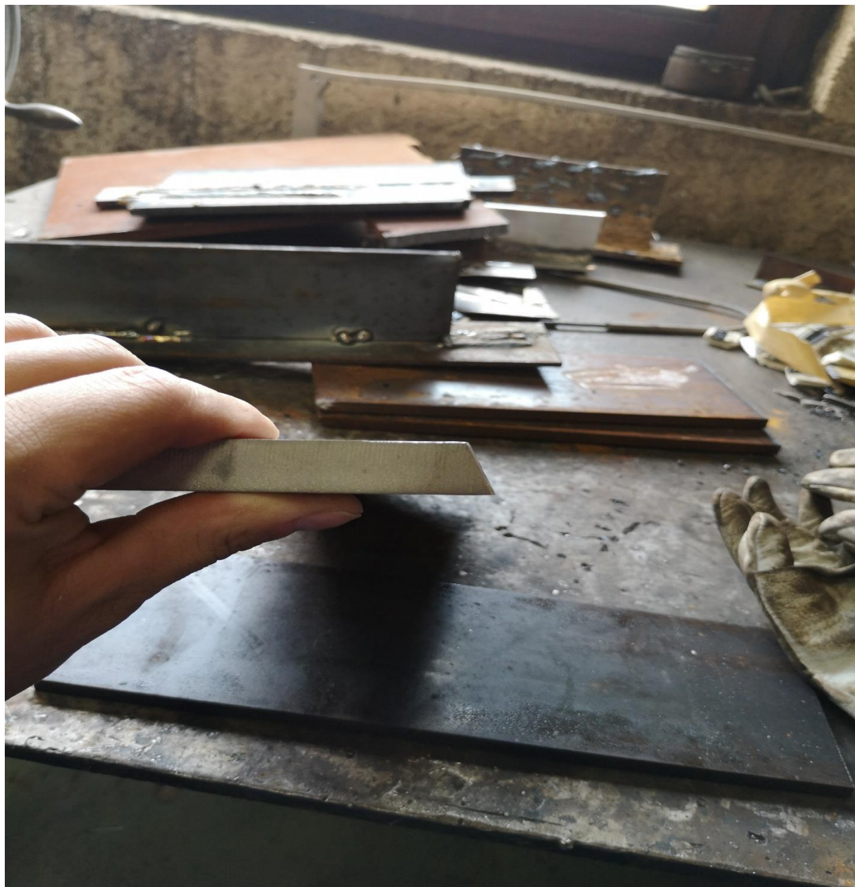
Slika 5 Obradjeni kut polovice spoja- 22.5^\circ
