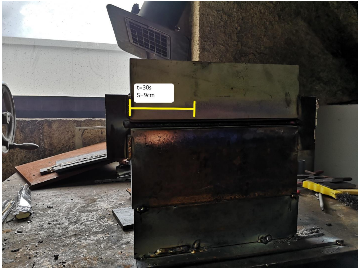
Slika 13 Mjerenje brzine zavarivanja
