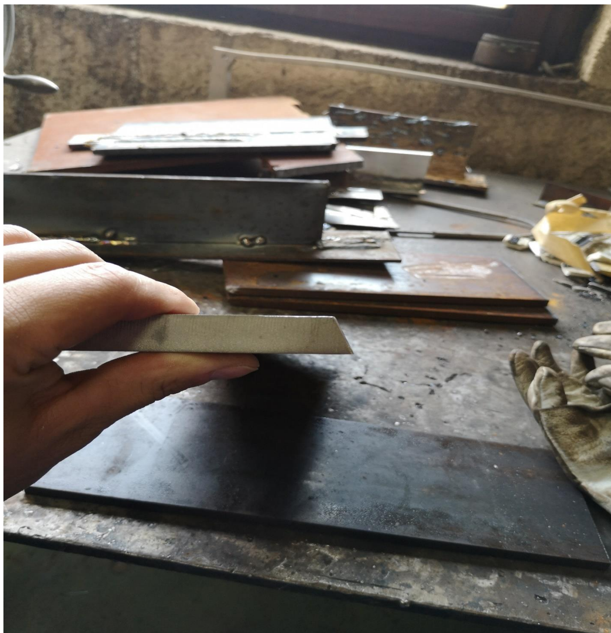
Slika 5 Obradjeni kut polovice spoja- 22.5^{\circ}
