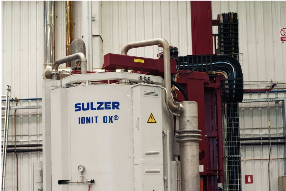
Slika 11. Peć za IONIT OX ® nitrokarburiranje tvrtke "Sulzer" [16]
