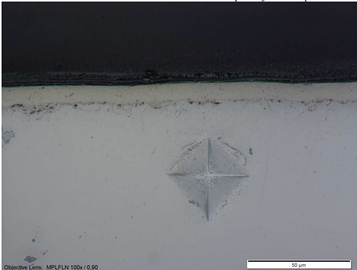
Slika 12. Difuzijska zona i zona spojeva snimljena na uzorku optičkim metalografskim mikroskopom Olympus BX51 u laboratoriju METRIS
