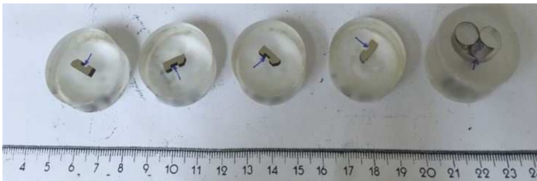
Slika 26. Nitrokarburirani uzorci pripremljeni za ispitivanje
