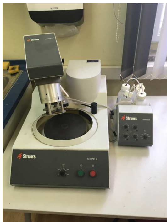
Slika 17. Uređaj za brušenje i poliranje Struers LaboPol-5
