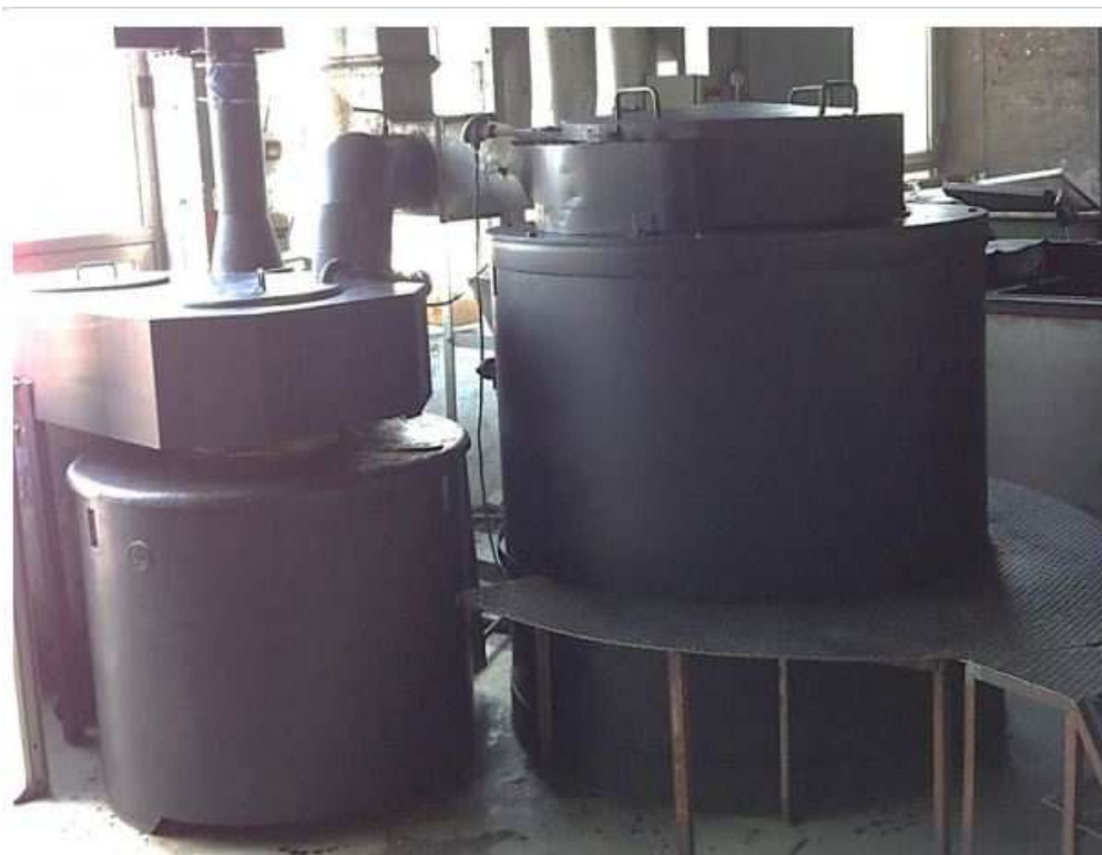
Slika 4. Solna kupka za nitrokarburiranje TENIFER [9]
