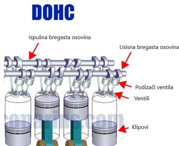
Slika 4 Dijagram DOHC motora
