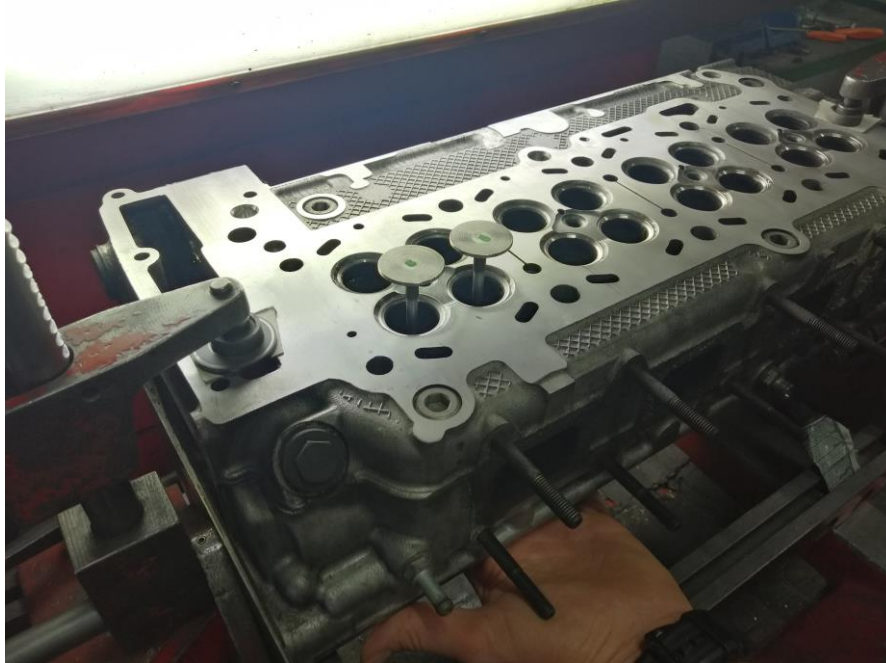
Slika 26 Primjer postavljene glave unutar stroja
