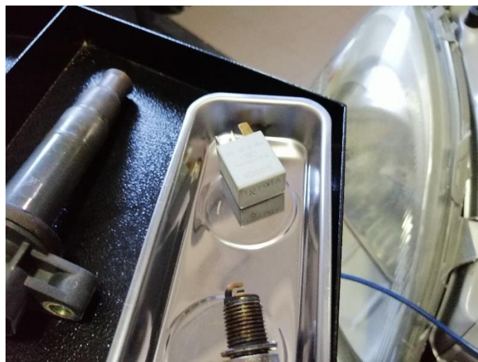
Slika 27 Relej dovoda goriva Izvor: Autorska slika
