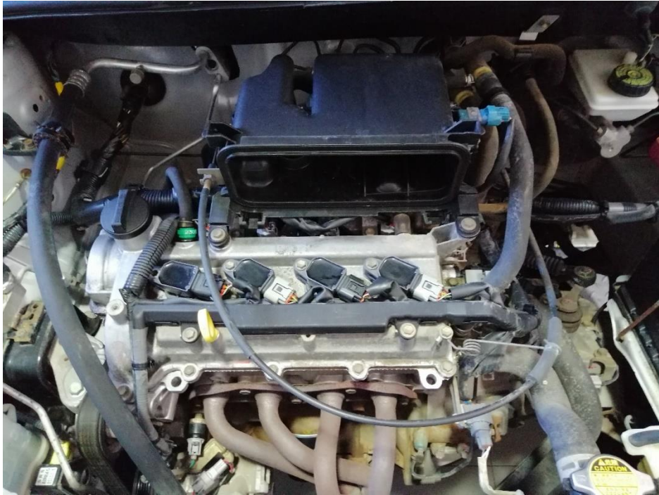
Slika 24 Motor bez usisa zraka Izvor: Autorska slika
