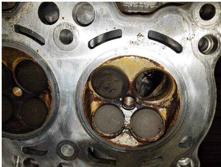
Slika 4 . Primjer razbijenog i iskrivljenog ventila. Izvor: https://i.redd.it/ipsbidvvtk201.jpg [Pristupljeno: 29.6.2019.]
