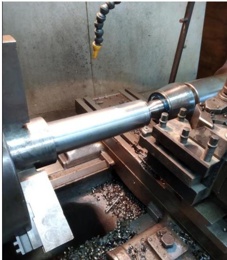
Slika 14. Prikaz komada fiksiranog u dvije točke
