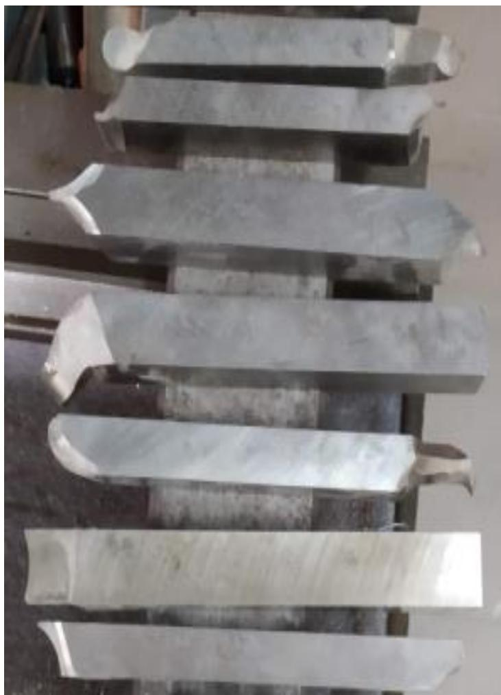
Slika 12. Jednodijelni tokarski noževi "Stirija"
