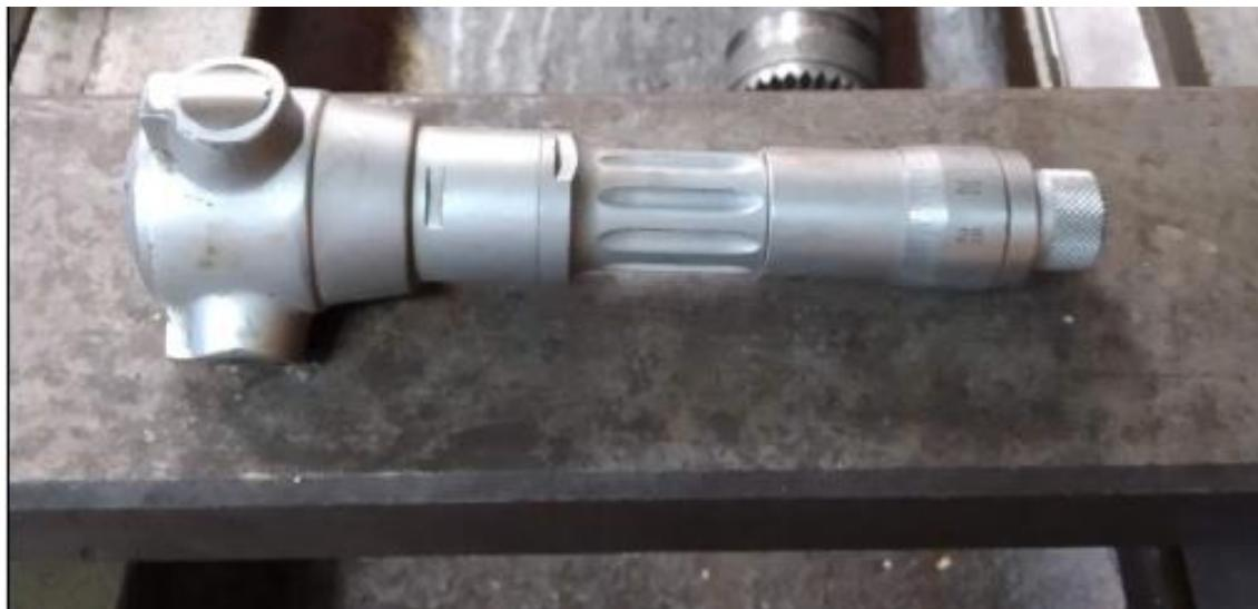
Slika 28. Mikrometar za provrte
