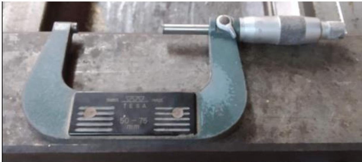
Slika 29. Mikrometar
