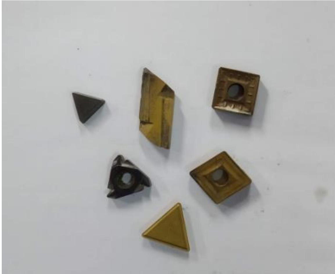
Slika 10. Vrste i oblici pločica za tokarenje
