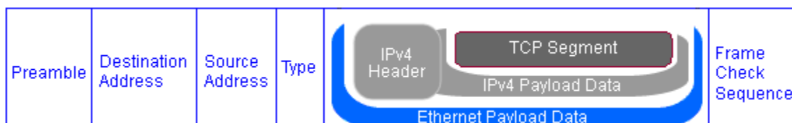
Slika 3. Ethernet okvir obuhvaćajući sloj 3 i iznad sloja 3.
