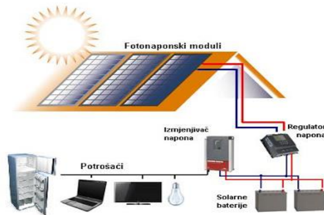
Slika 2 Samostalni fotonaponski sustav
