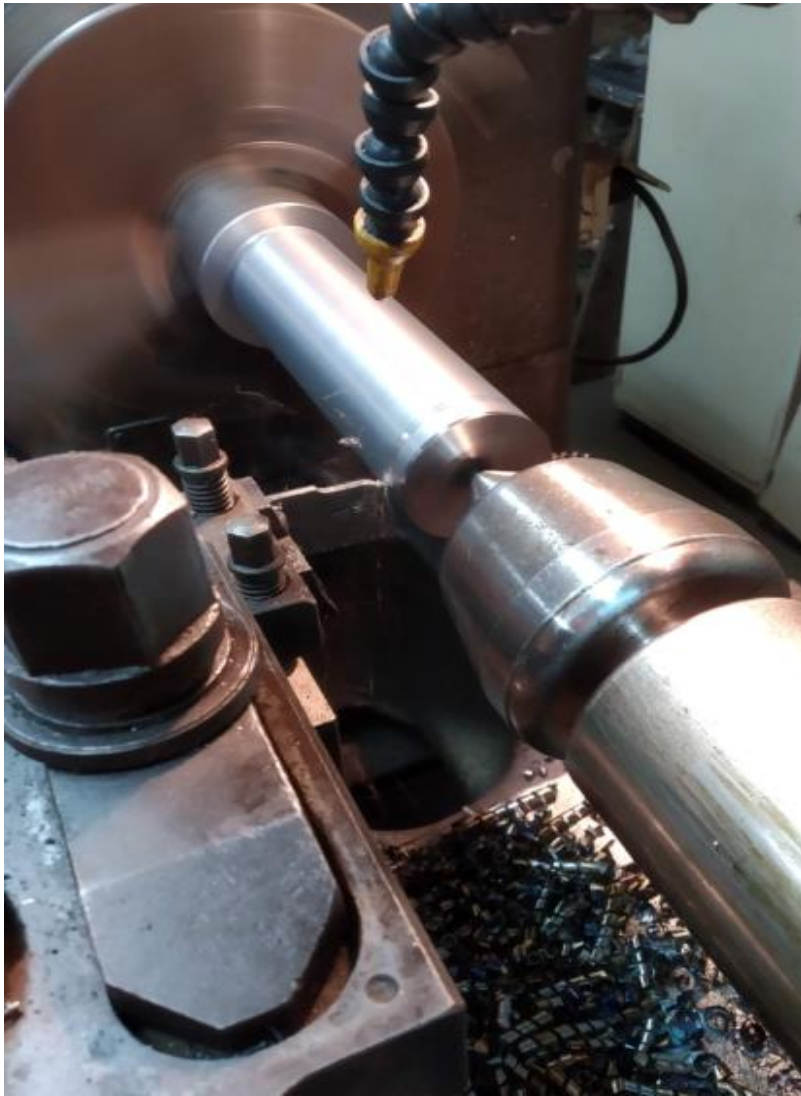
Slika 4. Uzdužno vanjsko tokarenje
