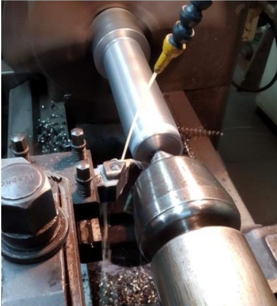
Slika 18. Prikaz emulzije za hlađenje i podmazivanje
