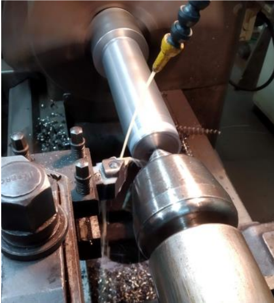
Slika 18. Prikaz emulzije za hlađenje i podmazivanje
