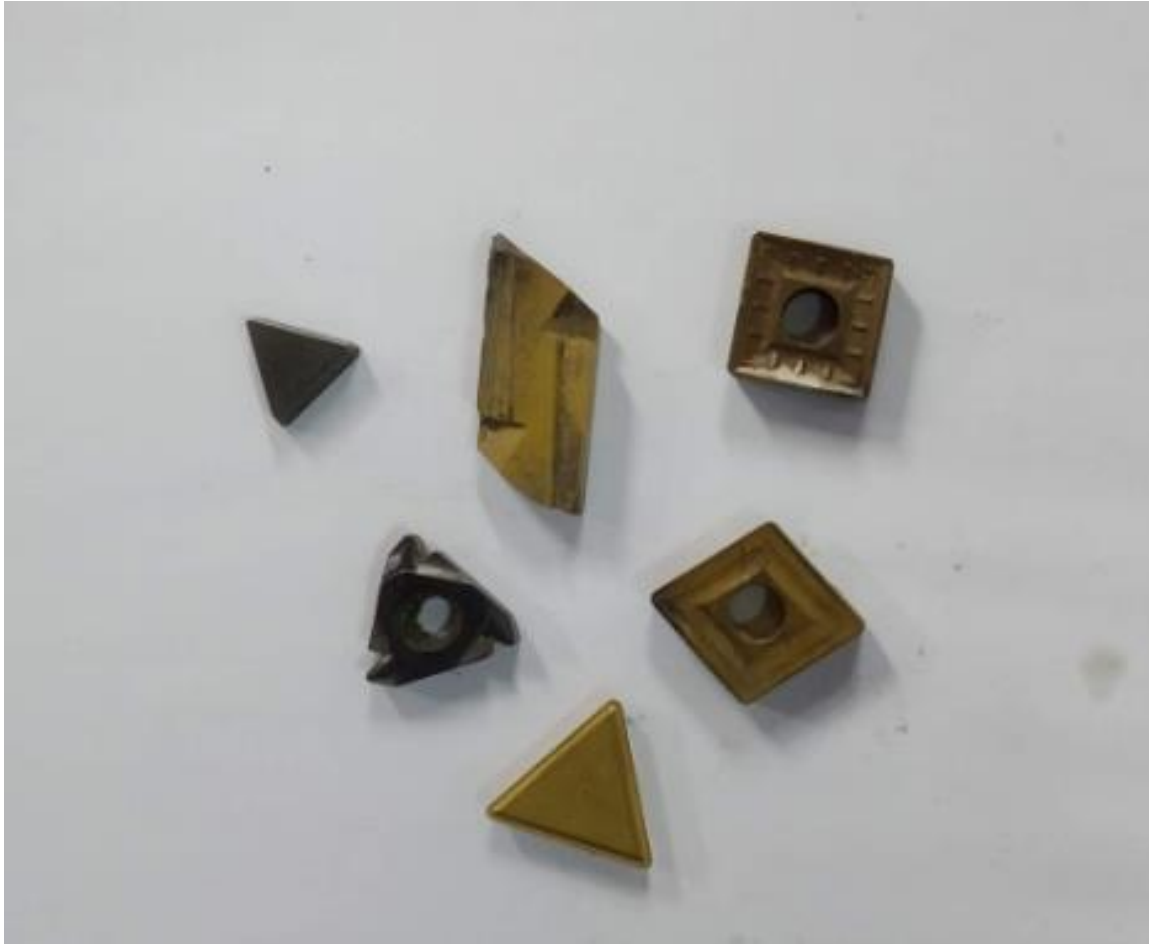
Slika 10. Vrste i oblici pločica za tokarenje
