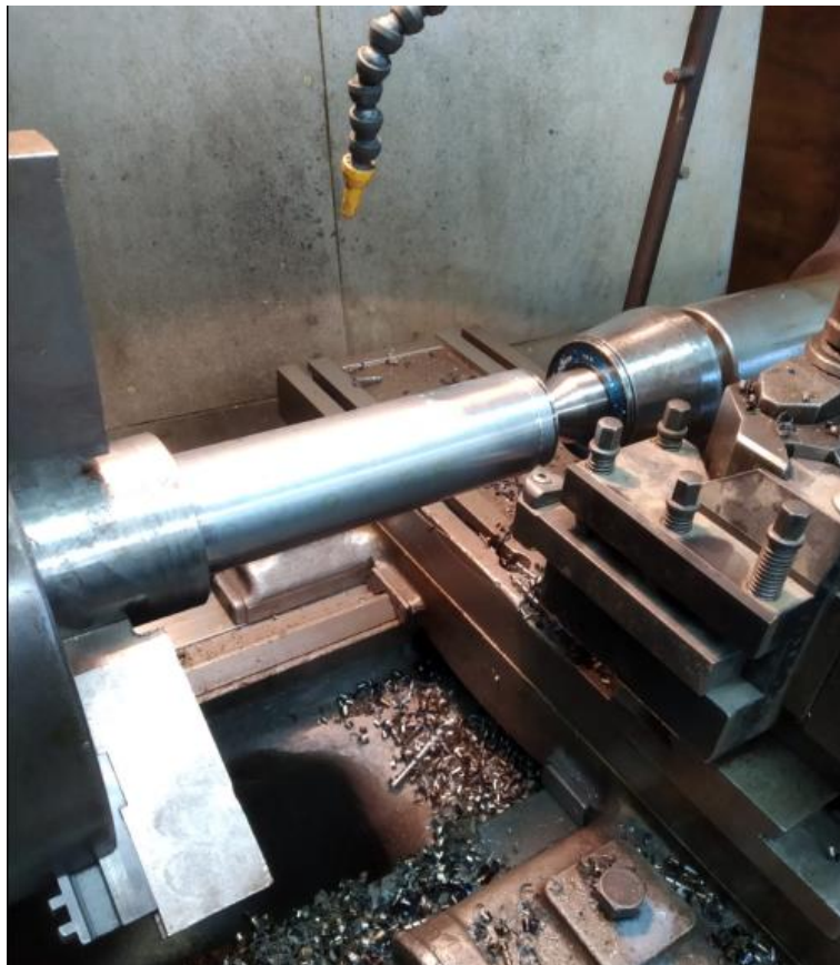
Slika 14. Prikaz komada fiksiranog u dvije točke
