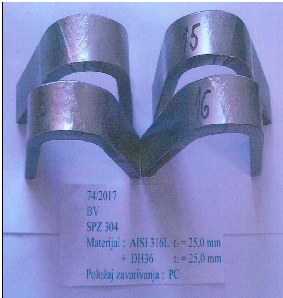
Slika 27 Epruvete nakon ispitivanja savijanjem
