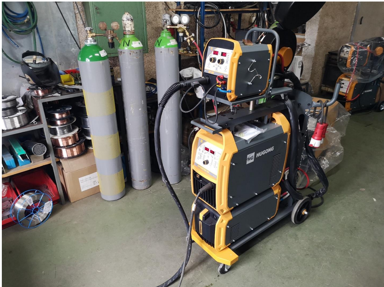
Slika 2 Aparat za MAG zavarivanje
