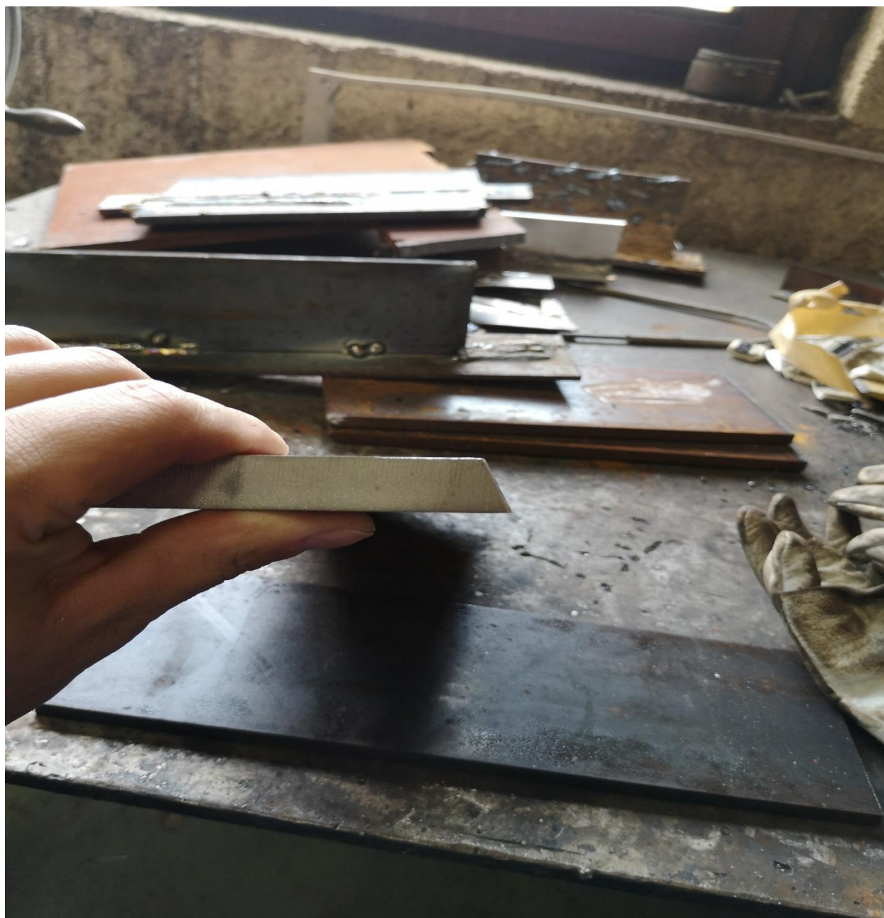
Slika 5 Obradjeni kut polovice spoja- 22.5^\circ
