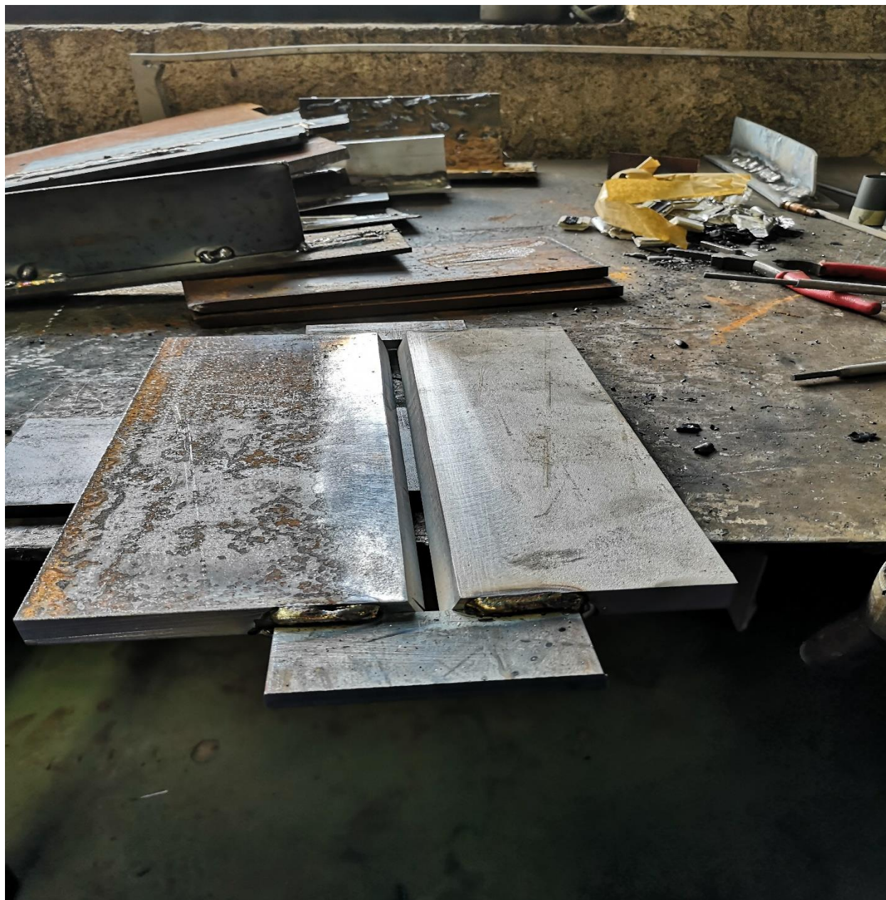
Slika 6 Pripremljeni "V" spoj
