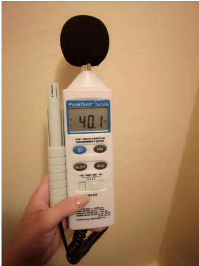
slika 7. mjerni instrument za mjerenje buke
