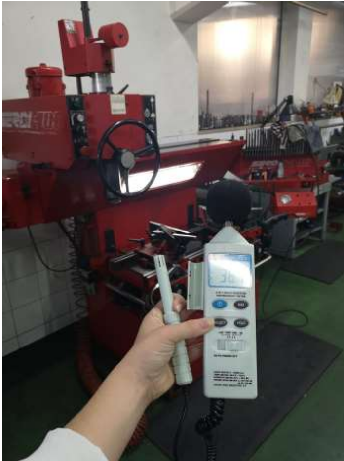
slika 7.5 mjerenje buke na radnom mjestu
