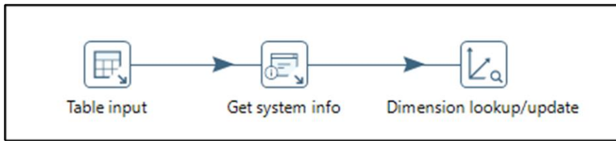
Slika 51. Prikaz transformacije za punjenje i/ili ažuriranje dimenzijske tablice
