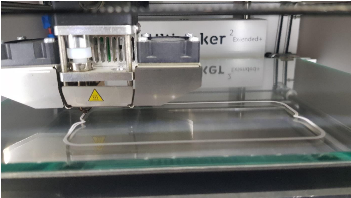
Slika 27 Početak printanja jednostupanjskog reduktora
