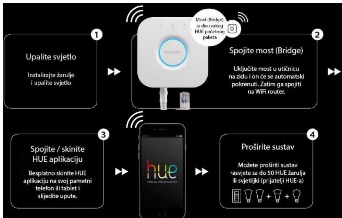
Slika 6: Instalacija Philips Hue sustava rasvjete Izvor: https://www.lighting.philips.hr/consumer/hue
