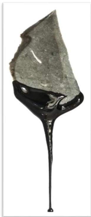
Slika 8. Katran dobiven metodom "pepela".
