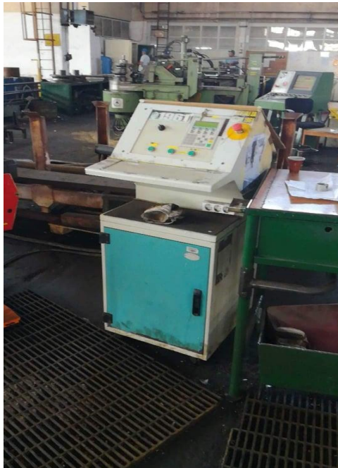
Slika 14. Savijačica Pedrazzoli s trnom, 2.
