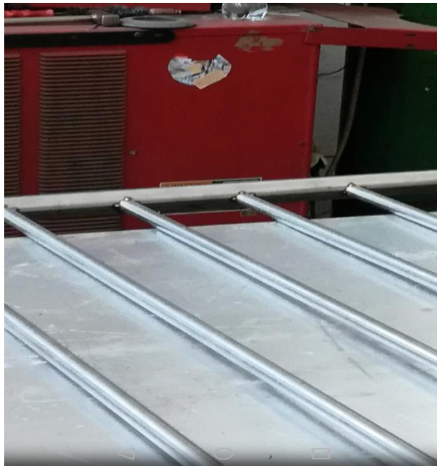
Slika 21. Puntiranje bez dodatka žice
