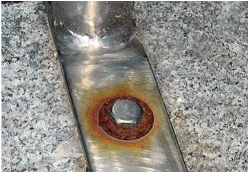
Slika 3 Česti primjer galvanske korozije koji se susreće u svakodnevnom životu. Izvor: https://qph.fs.quoracdn.net/main-qimg-dd1c9e2f7bbaf14ab142360f5cb6b03
