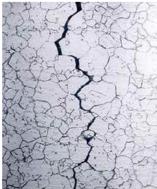
Slika 5 Mikroskopska slika pucanja pod korozivnim naprezanjem. Izvor: https://higherlogicdownload.s3.amazonaws.com/NACE/cedda8a4-c3c0-4583-b1b6-3b248e6eb1f2/UploadedImages/Resources/intergrainscc.jpg
