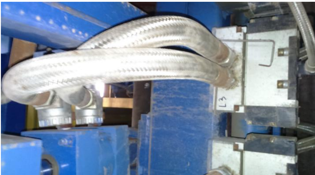
Slika 17 Pneumatski ventil i fleksibilne cijevi spojene na pneumatski cilindar sa više položaja – magnetni separatori
