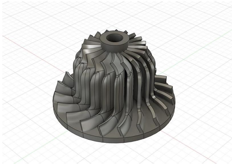
Slika 25 Prikaz modela impelera za turbine
