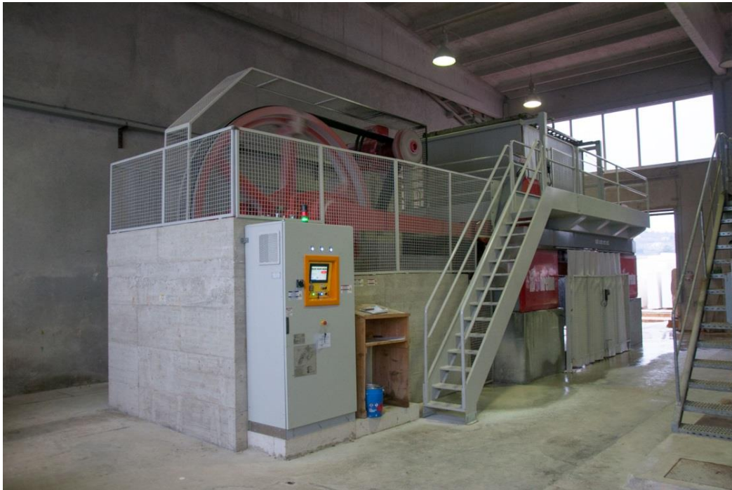
Slika 9: Gater Breton za obradu kamenih blokova
