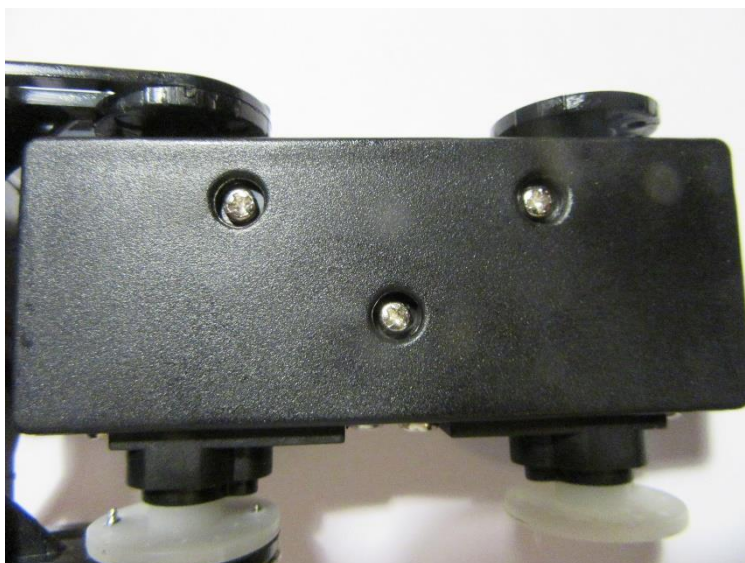
Slika 31: Kućište za dva servomotora Izvor: obrada autora
