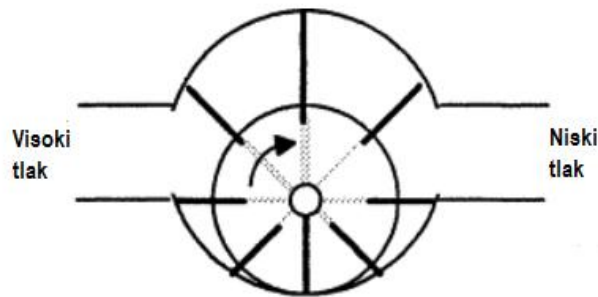
Slika 9: Princip rada hidrauličkog rotacijskog aktuatora sa lopaticama Izvor: Bolton (2015)
