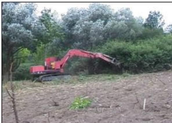
i čekića ili samo čekića (udarnih kopača) za udaranje, razbijanje ili aktiviranje ukopanih ili površinskih protupješačkih mina. Kabina bagera i pojedini dijelovi bagera moraju biti oklopljeni radi zaštite od krhotina eksplozije. Koristi se pri razminiranju kosina, nasipa, usjeka i sl.
