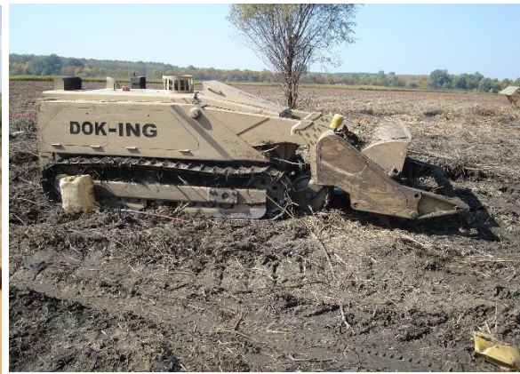
Slika 6: Stroj MV-4 kojeg proizvodi hrvatska tvrtka DOK-ING (Izbor, mrežna stranica tvrtke)
