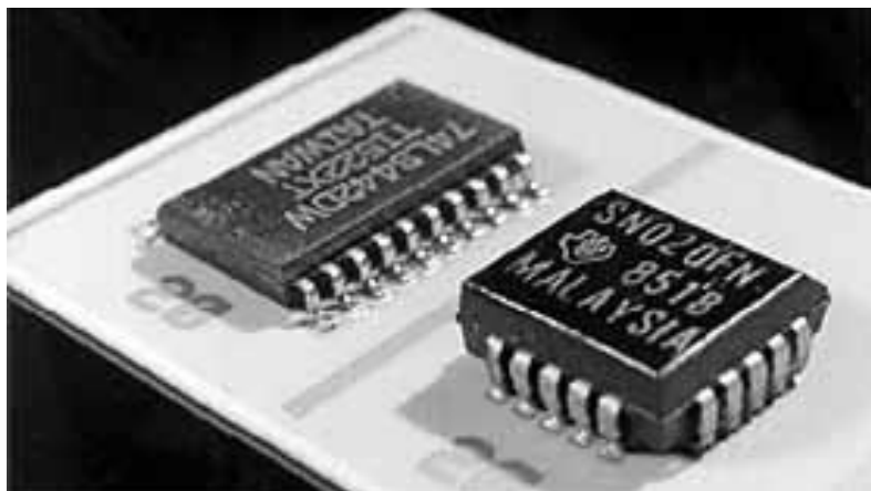
Slika 26: Keramičke podloge za električne uređaje
