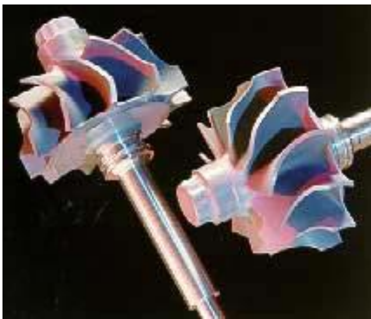
Slika 27: Keramički sklop rotora turbopuhala od silicijevog nitrida
