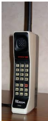
Slika 1 Motorola DynaTAC bio je težak blizu 1kg, omogućavao je oko 30 minuta razgovora te je trebalo 10 sati da se napuni (izvor: https://www.cengn.ca/wp-content/uploads/2020/09/DynaTAC-1G.png )
