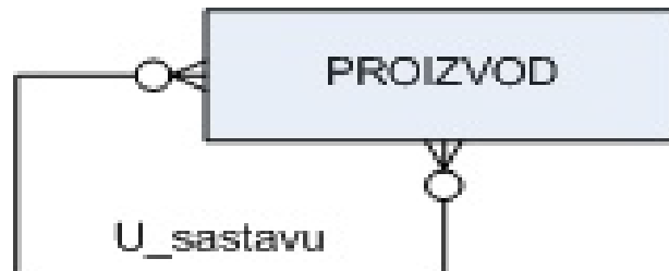
Slika 3.5. Konceptualni model - Unarna veza
