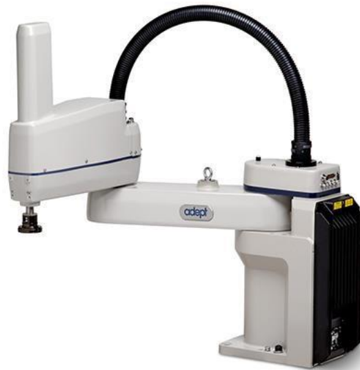
Slika 6. Robot AdeptOne SCARA, proizveden 1984.
