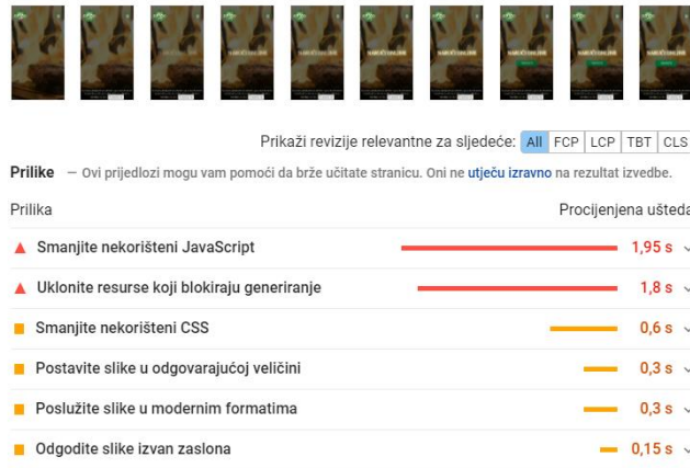
Slika 18: Prikaz prijedloga koje je potrebno ukloniti za brže učitavanje na mobilnim uređajima u alatu PageSpeed Insights
