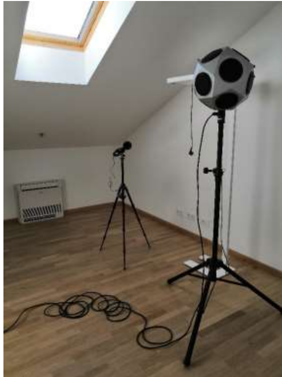
Slika 39. slikovni prikaz postupka mjerenja buke
