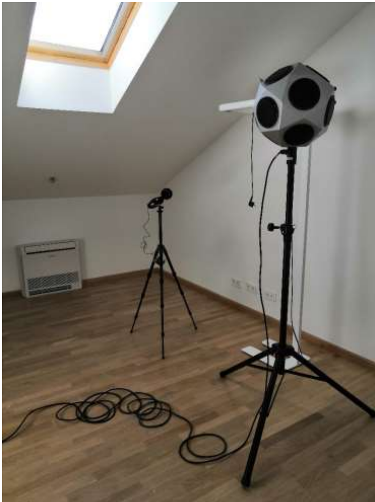
Slika 21. proces ispitivanja buke u uredskim prostorijama
