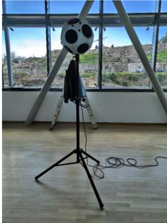
Slika 42. Uređaj za generiranje izvora zvuka (šuma)
