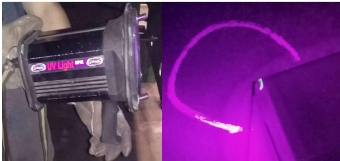
Slika 32. Ispitivanje zavora na nepropusnost fluorescentnim penetrantom (Izvor: NDE/NDT Resource Center https://www.nde-ed.org/AboutNDT/aboutndt.htm [19] )
