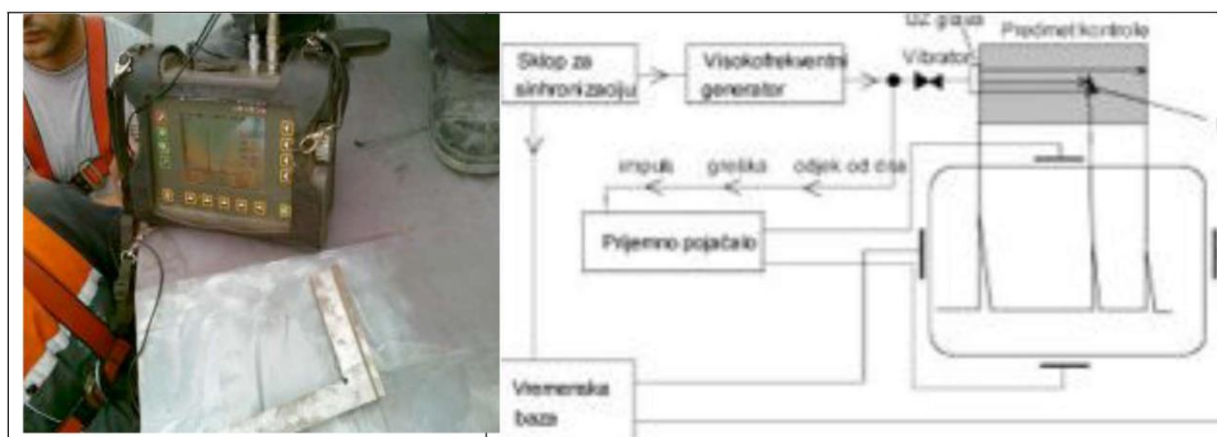
Slika 58. Primjer ultrazvučnog ispitivanja zavara 2/2 (Izvor: obrada autorice)
