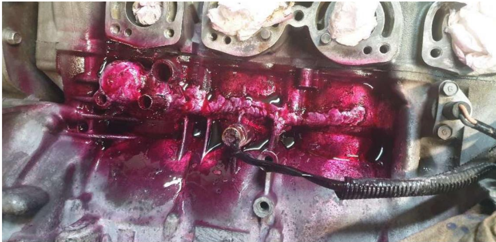
Slika 53. Nakon zavarivanja ponovno se pristupilo penetranskom ispitivanju (Izvor: obrada autorice)
