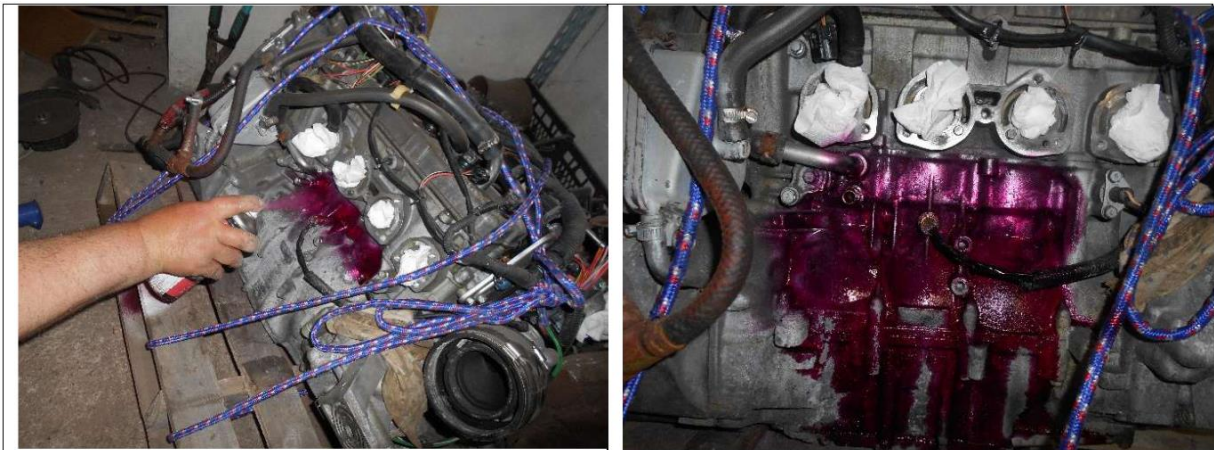
Slika 48. Prema uputi proizvođača čekalo se 20 minuta da se penetrant upije i zatim se isprao vodom i nakon toga se ponovno očistio razrjeđivačem (Izvor: obrada autorice)
