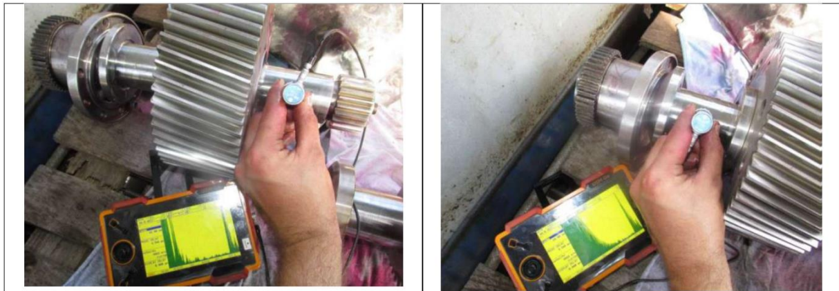
Slika 42. Ispitivanje ležajnih rukavaca kod pogonskog zupčanika
