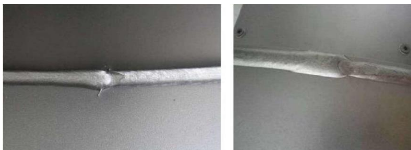
Slika 24. Nepravilno izveden nastavak zavar - (Izvor: www.twi-global.com )
