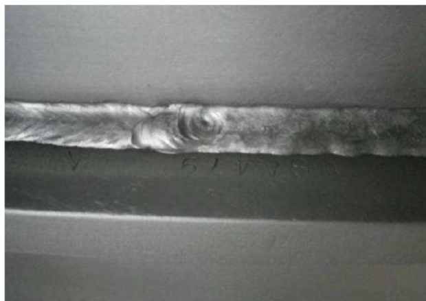
Slika 5. Šupljina ili poroznost u završnom krateru
