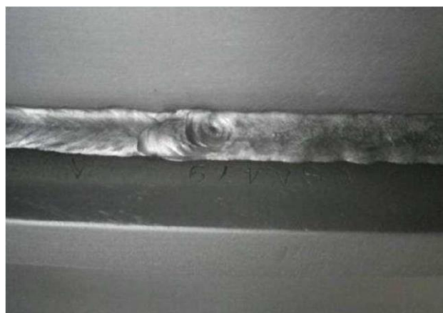
Slika 5. Šupljina ili poroznost u završnom krateru
