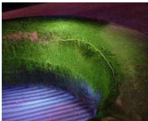
Slika 37. Pukotina vidljiva ispitivanjem magnetskih čestica
