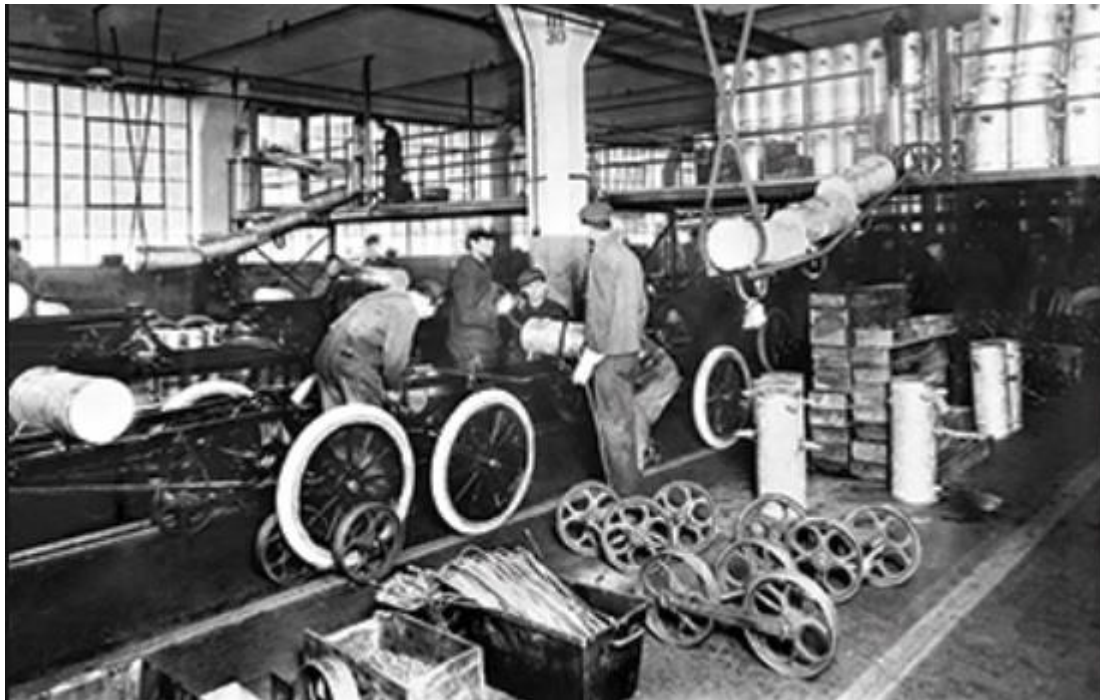
Slika 5. Traka za proizvodnju automobila
