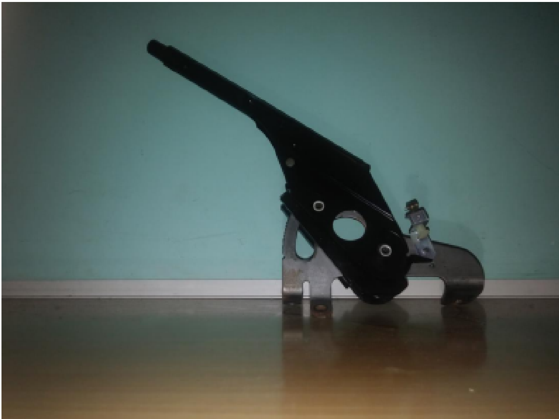
Slika 13. Prikaz ručne poluge u zategnutom stanju
