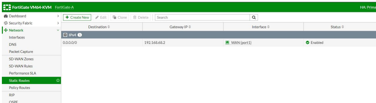
Slika 38. Prikaz statičke rute prema Internet vezi Izvor: samostalna izrada, 2022.
