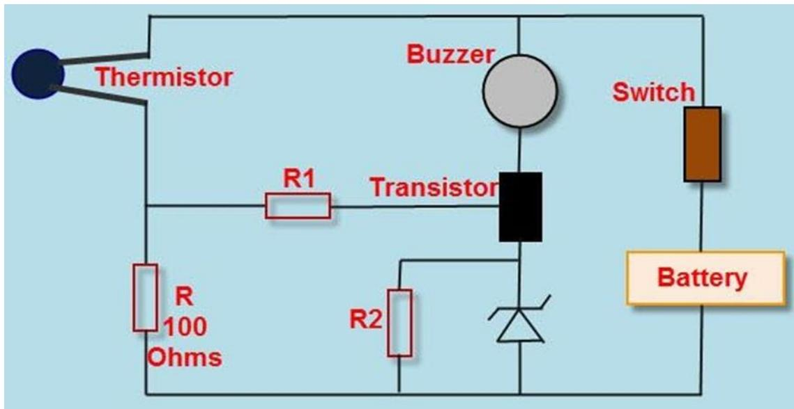
Slika 12. Predodžba jednostavne sheme dojave požara sa jednim termistorom
