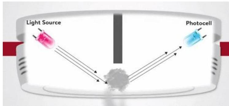
Slika 14. Predodžba rada detektora dima sa principom raspršivanja svjetlosti
