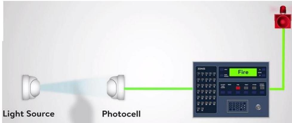
Slika 15. Predodžba rada detektora dima sa principom zatamnjenja svjetlosti
